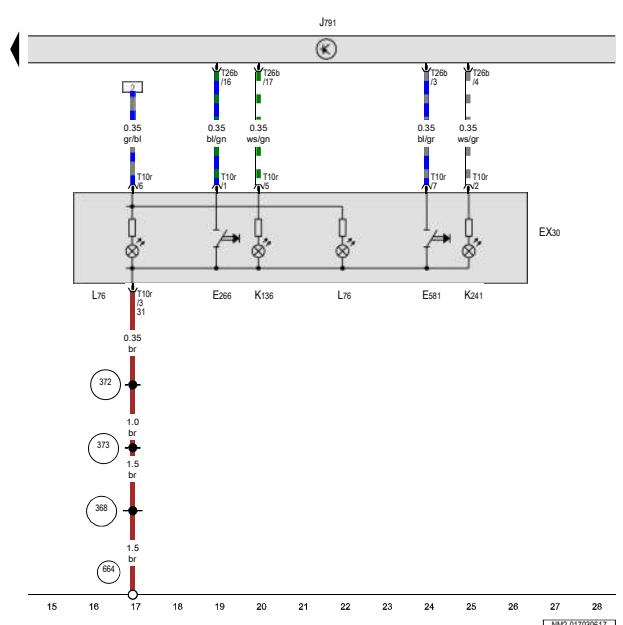
中控台开关模块 2, 泊车雷达系统按钮, 泊车转向辅助系统按钮, 泊车转向辅助系统控制单元, 泊车雷达系统指示灯, 泊车转向辅助系统指示灯, 按钮照明灯泡
